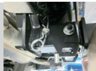
Тип соединения: шаровый; Тип шара «Е»; Диаметр сцепного шара: 50 мм.; Масса комплекта ТСУ LRX991102: 18,4 кг.
