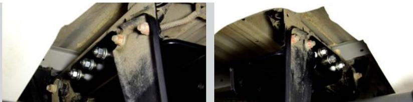
**ШАГ 3.** Установите закладную пластину в нишу левого лонжерона продев шпильки пластины в отверстия лонжерона и кронштейна как показано на фото. Закрепите кронштейн с помощью гаек М12 через пружинные шайбы М12 и шайбы М12. Повторите на правой стороне.
