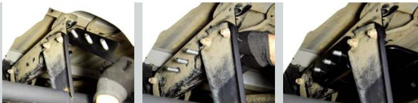
**ШАГ 2.** Закрепите кронштейн на шпильках с помощью гаек М12 через пружинные шайбы М12 и шайбы М12. Повторите шаг 1 и 2 для правой стороны автомобиля. Если кронштейны упираются в трубу бампера, ослабьте её и подайте вперёд.
