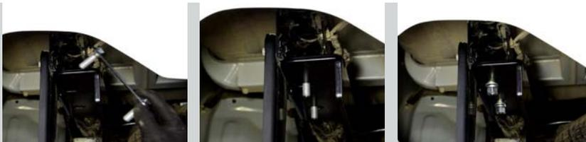
**ШАГ 4.** Для установки фаркопа совместите отверстия в сварном кронштейне с отверстиями в кронштейнах и соедините всё с помощью болтов М10, через шайбы М10 и шайбы пружинные М10, затянув гайками М10. Затяните все резьбовые соединения.
