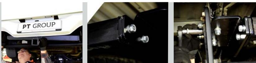
**ШАГ 5.** Установите кронштейн крепления электрической розетки. Установите съемный шар в сборе и закрепите его пальцем гнутым со шплинтом. Зафиксируйте съемный шар болтом М10х20. Затяните шар ключом на 38. Установка завершена.
