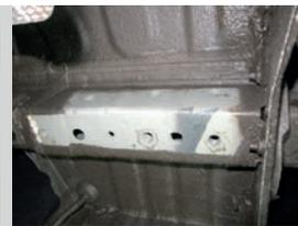
**ШАГ 2.** Установите кронштейн левый, совместив отверстия кронштейна с отверстиями в лонжероне автомобиля и соедините их с закладными пластинами с помощью болтов M10x40x1,25 через шайбы M10 и гроверные шайбы M10.
