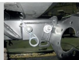
**ШАГ 5.** Затяните шар с помощью ключа на 38 мм. Вкрутите стопорный винт M10x20 снизу. Установите задний бампер согласно руководства по ремонту автомобиля. Установка завершена. Шар в сборе может устанавливаться по вылету в два положения.
