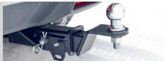
Тип соединения: шаровый; Диаметр сцепного шара: 50 мм.; Масса комплекта ТСУ 08101501: 17,9 кг.
