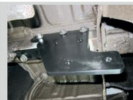
**ШАГ 4.** Установите кронштейн сварной, совместив отверстия в боковых кронштейнах с отв-ми балки и соедините их с помощью болтов M10x40 через шайбы и гроверные шайбы M10. Установите кронштейн крепления розетки, шар в сборе и зафиксируйте его шплинтом.
