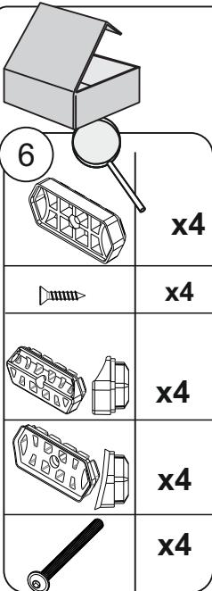
В комплекте багажника поставляются дополнительные элементы для улучшения прилегания внутреннего прижима к рейлингам различной формы. Для узких рейлингов (менее 25мм) можно использовать дополнительную проставку внутреннего прижима из комплекта поставки.
