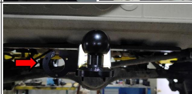
**ШАГ 3.** Установите съемный шар (поз. 9) закрепив его пальцем (поз. 5) и шплинтом (поз. 13). Закрепите съемный шар болтами М12 (поз. 10) через шайбы 12 и пружинные шайбы 12 (поз. 11, 12) как указано на схеме в паспорте.
