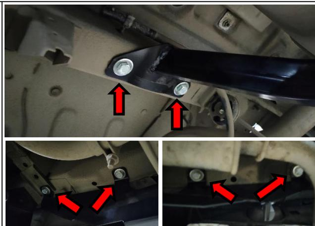
**ШАГ 2.** Установите кронштейн розетки (поз. 6) и закрепите ее гайкой М8 (поз. 7) через шайбу 8 пружинную (поз. 8). Подключите электрику: розетку, жгут проводов, блок согласования (если требуется).
