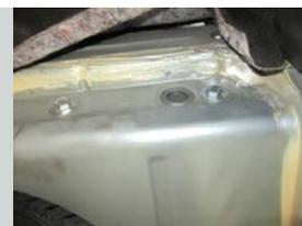
**ШАГ 2.** Установите кронштейны и закрепите их на болтах M12x110x1,25 с помощью гаек M12x1,25 через шайбы и гроверы как показано на схеме. Предварительно разместите закладные пластины как показано на фото. Соединения не затягивать.
