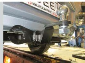
Тип соединения: шаровый; Диаметр сцепного шара: 50 мм.; Масса комплекта ТСУ 02041501: 16,2 кг.
