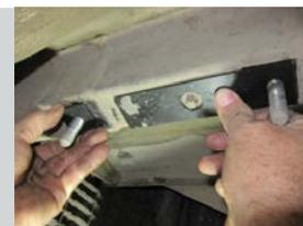
**ШАГ 3.** Установите центральный кронштейн совместив отверстия в боковых кронштейнах и в центральном. Закрепите кронштейн центральный с помощью болтов M10x30x1,25 через шайбы на 10 и гроверы на 10 гайками M10x1,25. Отрегулируйте положение центрального кронштейна и затяните все резьбовые соединения.
