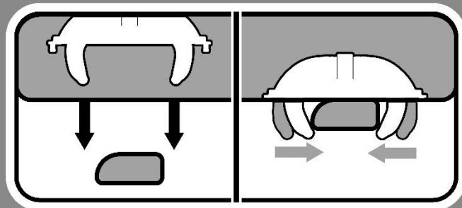
Максимально закрутите крепление до полного сжатия «клапок» на поперечинах.
