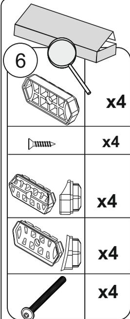
В комплекте багажника поставляются дополнительные элементы для улучшения прилегания внутреннего прижима к рейлингам различной формы. Для узких рейлингов (менее 25мм) можно использовать дополнительную проставку внутреннего прижима из комплекта поставки.
