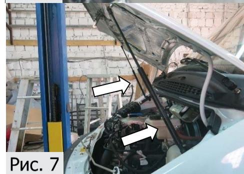
4. Завести гайку закладную в отверстие **B**. Совместить резьбовое отверстие в гайке закладной с отверстием в капоте **Г** (рис.4,5).
