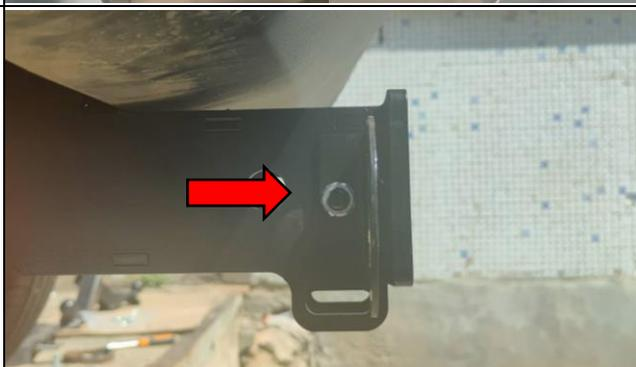
**ШАГ 4.** Установить съемный шар (поз. 13) закрепив его пальцем (поз.9) и шплинтом (поз. 11). Закрепить съемный шар болтами М12 х1,25х35 (поз. 12) через шайбы 12 и пружинные шайбы 12 (поз. 5,6).
