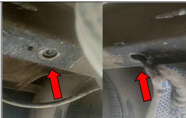
**ШАГ 2.** Установите боковые кронштейны - левый и правый (поз. 15), прикрутив болтами М10х1,25х35 (поз.1) через шайбы 10 увел. и шайбы 10 пружинные (поз.2,3) к боковым стенкам лонжерона и закладной лонжерона (поз. 4) как указано на фото и на схеме в паспорте. Установите центральную перекладину (поз 8), соединив ее с боковыми кронштейнами (поз. 15) с помощью болтов М12х1,25х35 (поз. 12), шайб 12 (поз. 5) и шайб 12 пружинных (поз.6). Затяните соединения всех элементов.
